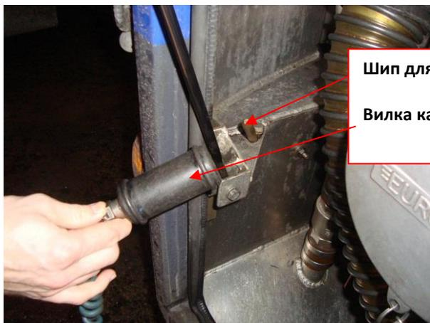
**Шип для соединения с вилкой кабеля заземления**
